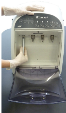
Abb.14 – Verbinden einer Turbine mit Midwest 4-Loch Anschluss
