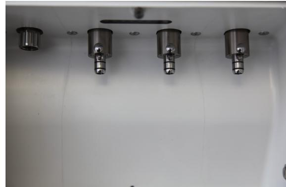
Abb.18 – iCare+ C3 mit Adaptern für 3 Winkelstücke
