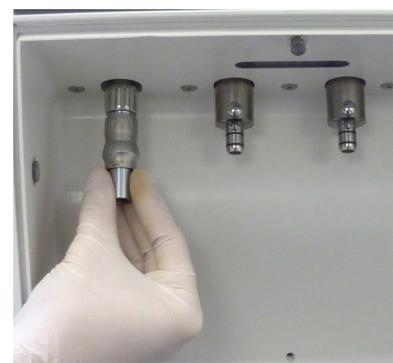
Abb.16 – Anbringen des Kupplungsadapters
