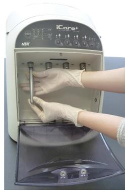
Abb.15 – Festdrehen des Halterings
