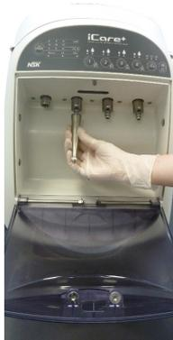
Abb.17 – Verbinden eines Winkelstücks
