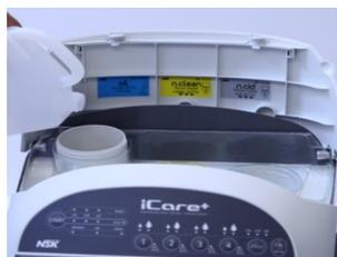
Abb.12 – Füllen des Öltanks
