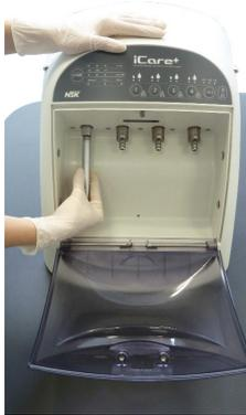
Abb.14 – Verbinden einer Turbine mit Midwest 4-Loch Anschluss
