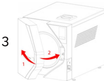
Bevor Sie die Tür schließen, heben Sie den Griff ganz an, bringen Sie die Tür nach vorne und drehen Sie den Griff gegen den Uhrzeigersinn, bis er die senkrechte Position erreicht.
