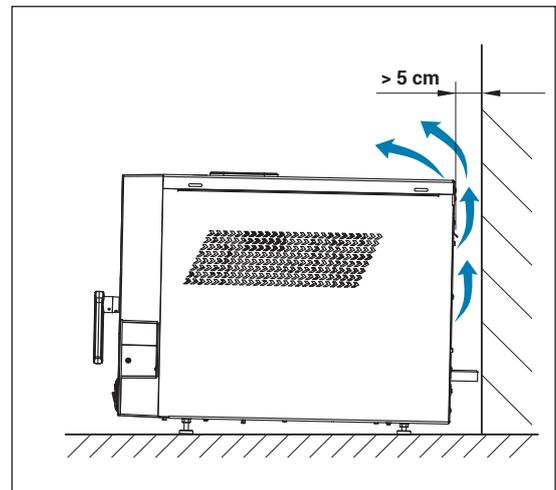
**⚠ Das Sicherheitsventil befindet sich auf der Rückseite des Geräts. Wenn er durch Überdruck ausgelöst wird, gibt er sehr heißen Dampf an die Umgebung ab. Positionieren Sie das Gerät so, dass keine Verbrennungsgefahr für den Bediener besteht.**
