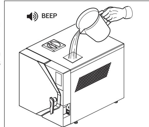
**Die Verwendung von minderwertigem demineralisiertem Wasser kann zu Kalkablagerungen auf den Instrumenten, im Inneren der Kammer und auf den Tablets führen. Lesen Sie das Etikett auf dem Behälter mit destilliertem Wasser sorgfältig durch. Verwenden Sie kein Leitungswasser, auch wenn es mit einem Filter oder Wasserenthärter behandelt wurde.**
