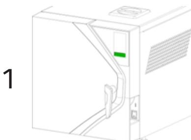
Das Vorhängeschloss-Symbol ist GRÜN: Die Tür ist verriegelt, durch Drücken des grünen Symbols wird die Tür entriegelt und das Symbol wird ORANGE.
