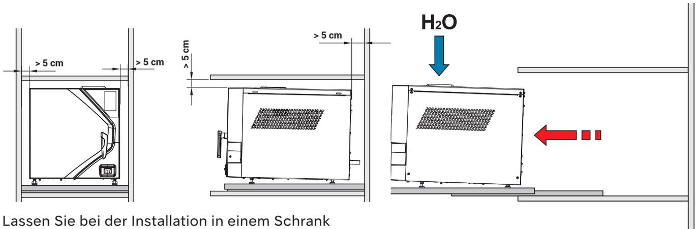
Lassen Sie bei der Installation in einem Schrank einen Lüftungsabstand von mindestens 5 cm zwischen der Unterseite des Regals und der Oberseite des Geräts.
