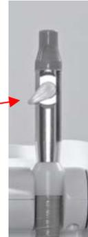
Die Absaugung schaltet sich ebenfalls automatisch ab, wenn der Sammelbehälter (12) voll ist und entleert werden muss.
