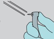
Bohrer aus dem Spannsystem entfernen und in Bohrerdesinfektionslösung einlegen
